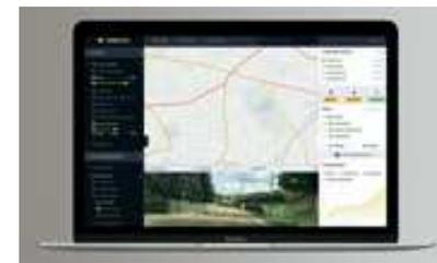
**Automatische Schadenserfassung:** Während einer Routinefahrt eines städtischen Fahrzeugs erledigen ein Smartphone und eine intelligente Software mit Machine Learning Algorithmen. Bei frühzeitiger Schadensbeseitigung soll auf lange Sicht eine Kostenersparnis von rund 80 Prozent realistisch sein.
